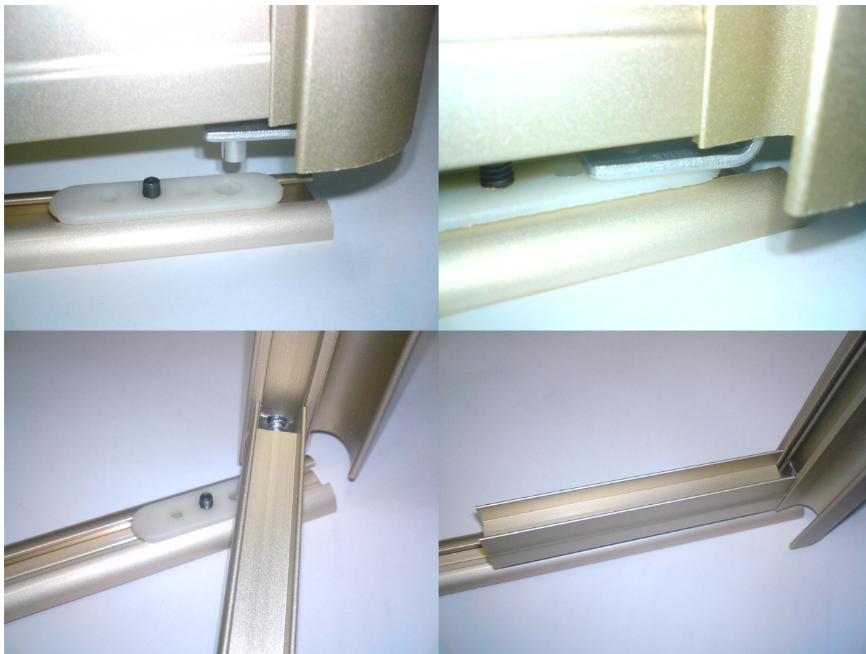
Рисунок 7. Установка поворотной двери-купе в трек
